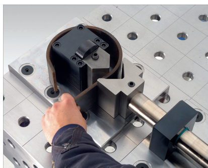
für geschlossene Teile; Matrize drückt in Stempel
