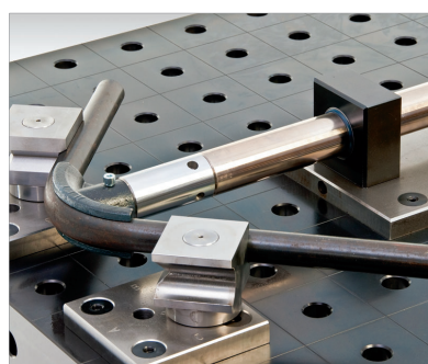
Rohrbiegen durch Drücken
