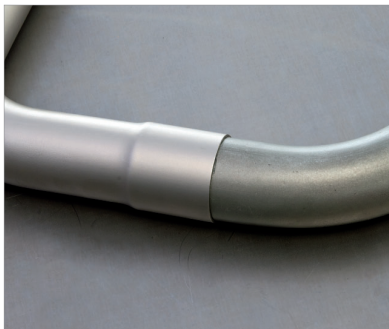
Verbindung nach Aufweitung
